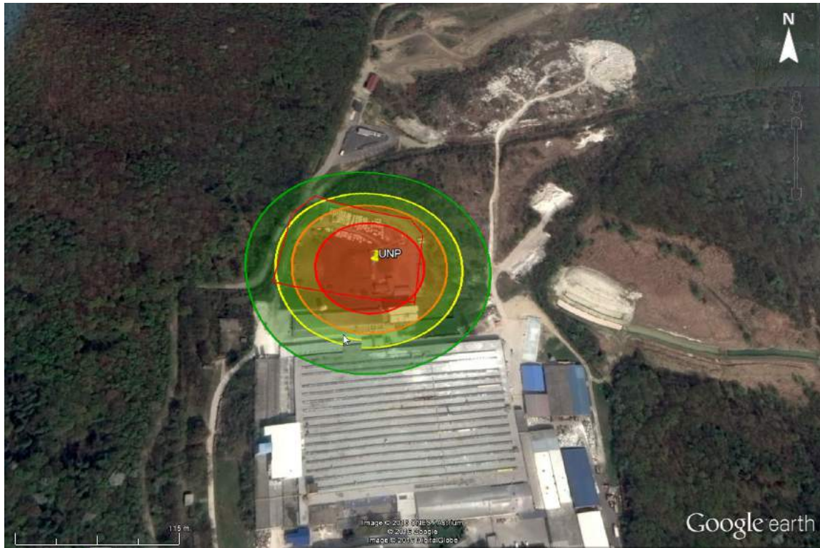
Slika 23. Zone ugroženosti uslijed istjecanja i požara UNP-a u svim spremnicima (trenutni kapacitet)
