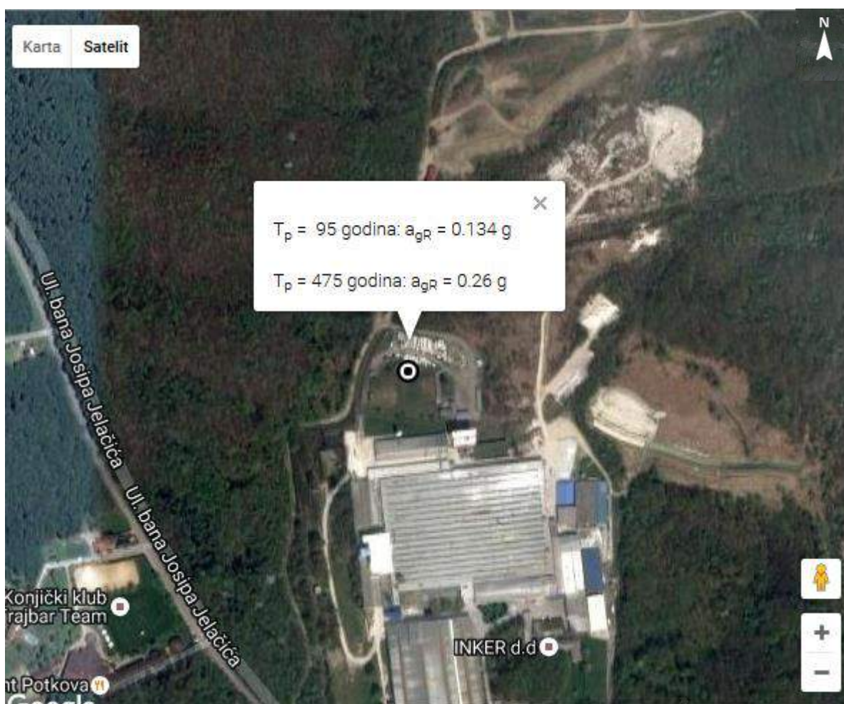
Slika 14. Iznosi vršnih ubrzanja tla za povratna razdoblja 95 i 475 godina za područje postrojenja Skladište Zaprešić
