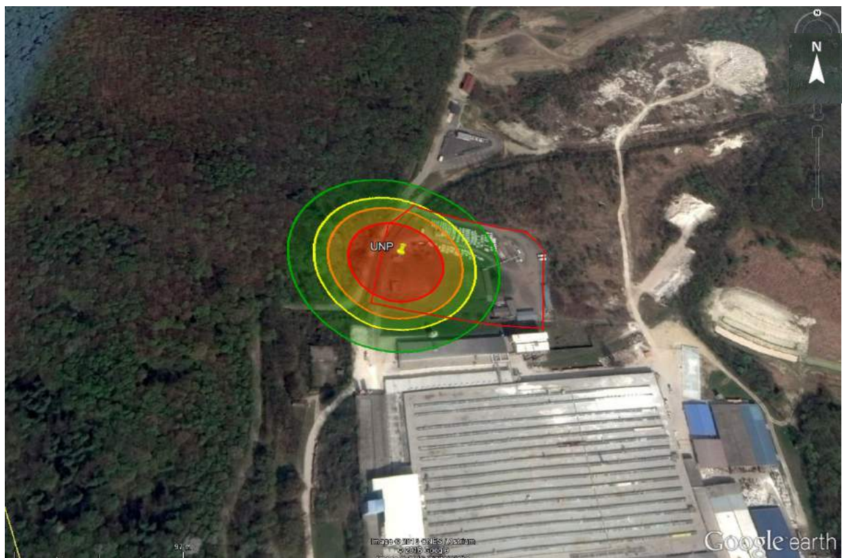
Slika 28. Zone ugroženosti uslijed istjecanja i požara UNP-a u vagoncisterni
