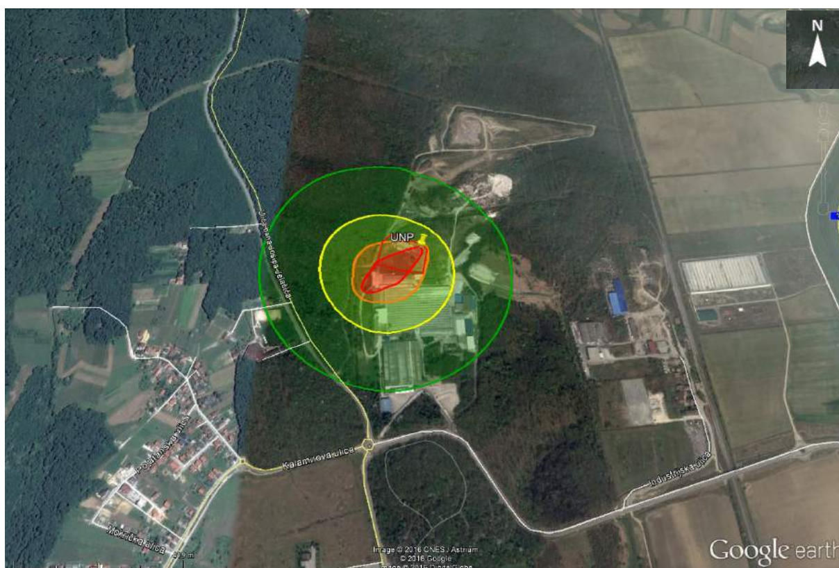
Slika 29. Zone ugroženosti uslijed istjecanja i eksplozije UNP-a u autocisterni
