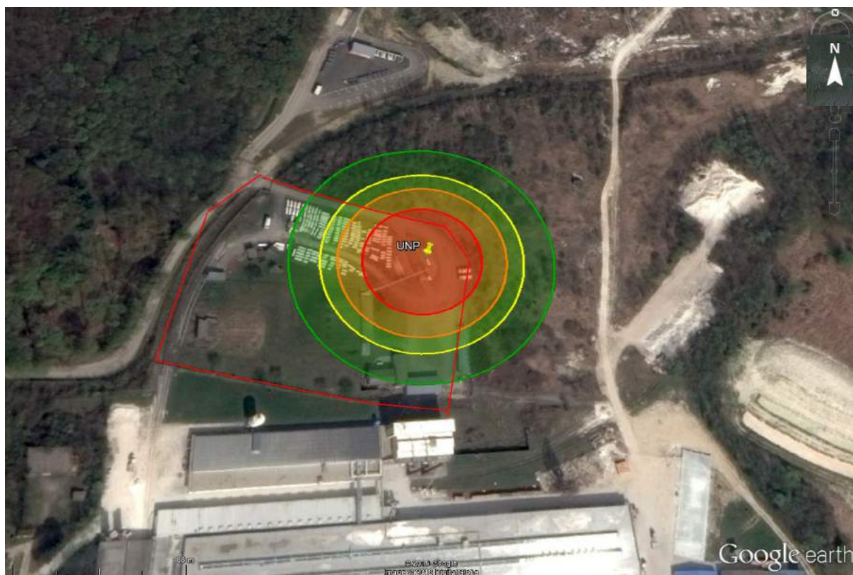
Slika 30. Zone ugroženosti uslijed istjecanja i požara UNP-a u autocisterni
