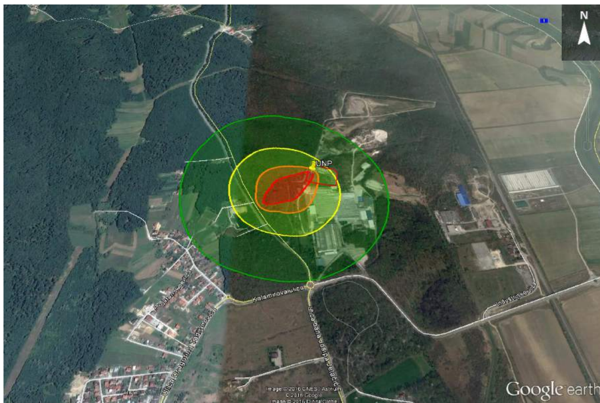
Slika 27. Zone ugroženosti uslijed istjecanja i eksplozije UNP-a u vagoncisterni
